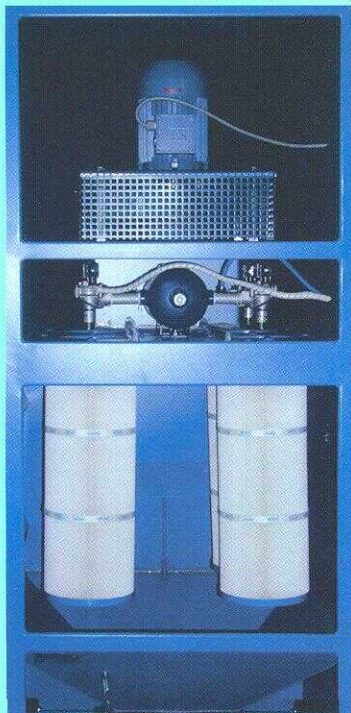
Schallgedämpfte Ventilator-kammer mit pneumatischer Abreinigungsmechanik. Großflächige Filterpatronen ( \approx 5 \text{ m}^2 ). Gute Zugänglichkeit durch große Wartungstüren.
