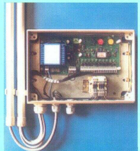
Elektrisches Steuergerät für die automatische Abreinigung der Filterpatronen. Pausenzeiten und Abreinigungsdauer sind je nach Staubanfall frei programmierbar.
